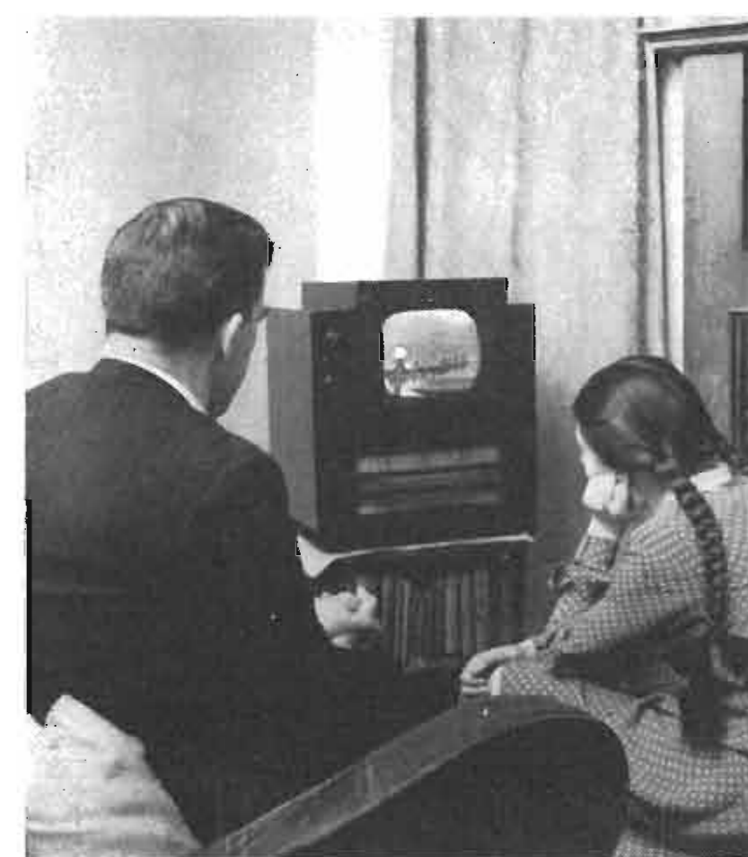
Questo ricevitore di televisione prodotto in Inghilterra è di tipo poco comune in quanto può ruotare su un dispositivo girevole per essere orientato nella direzione più favorevole per gli osservatori.
