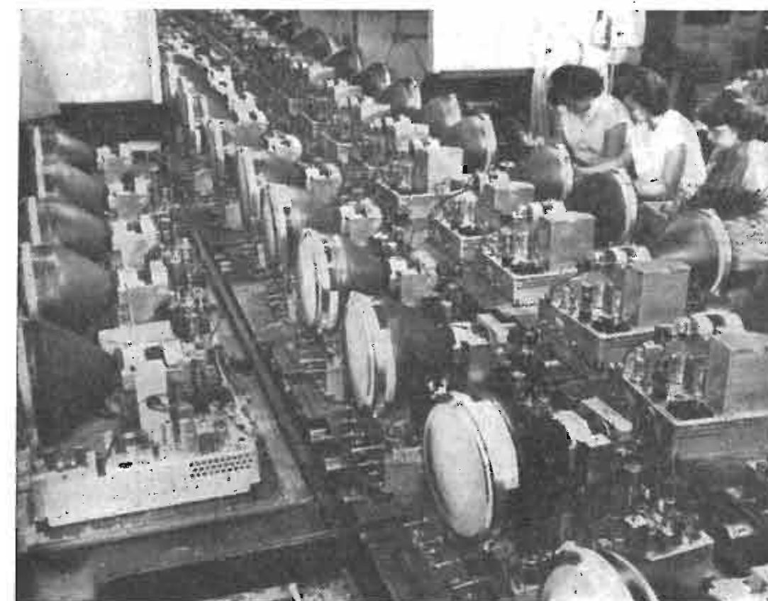
In una grande fabbrica americana gli apparecchi di televisione scorrono sulla linea di montaggio per gli ultimi ritocchi prima della sistemazione definitiva nel mobile. Nel 1949 sono stati prodotti negli Stati Uniti 2.400.000 ricevitori di televisione.
