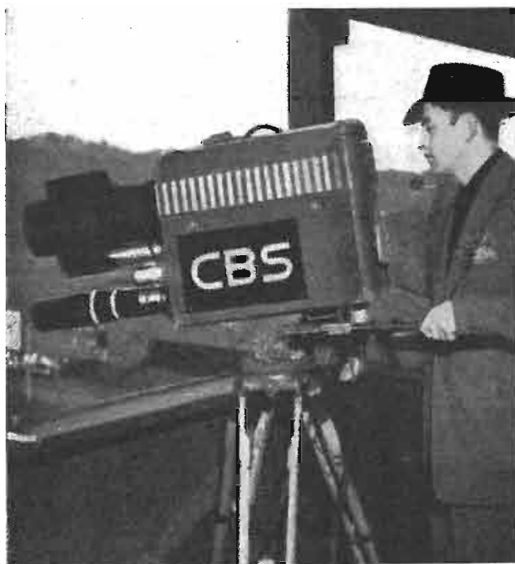
Camera da presa televisiva della CBS munita del nuovo obiettivo a lunghezza focale variabile che sostituisce vantaggiosamente la torretta coi relativi obiettivi grandangolari, normali e teleobiettivi.
